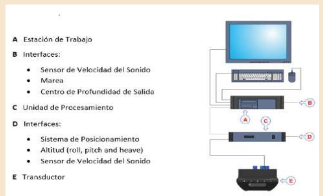
Figura 5: Diagrama del Sistema Multihaz 2040 P.
