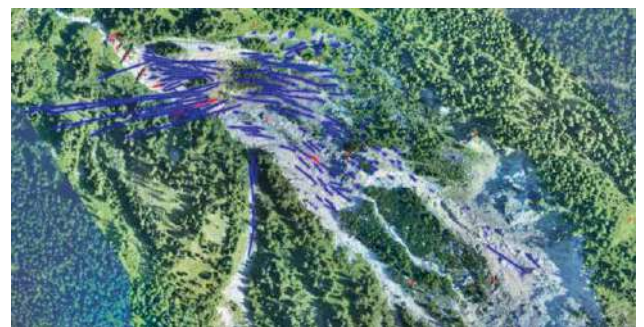
Figura 7. A partir de esta imagen, es posible comparar qué parte del terreno se mueve más rápido o más lento. La longitud de los trazos representan la velocidad del movimiento de la tierra. Cuanto más largo sea el trazo, más rápido será el movimiento de la tierra.
