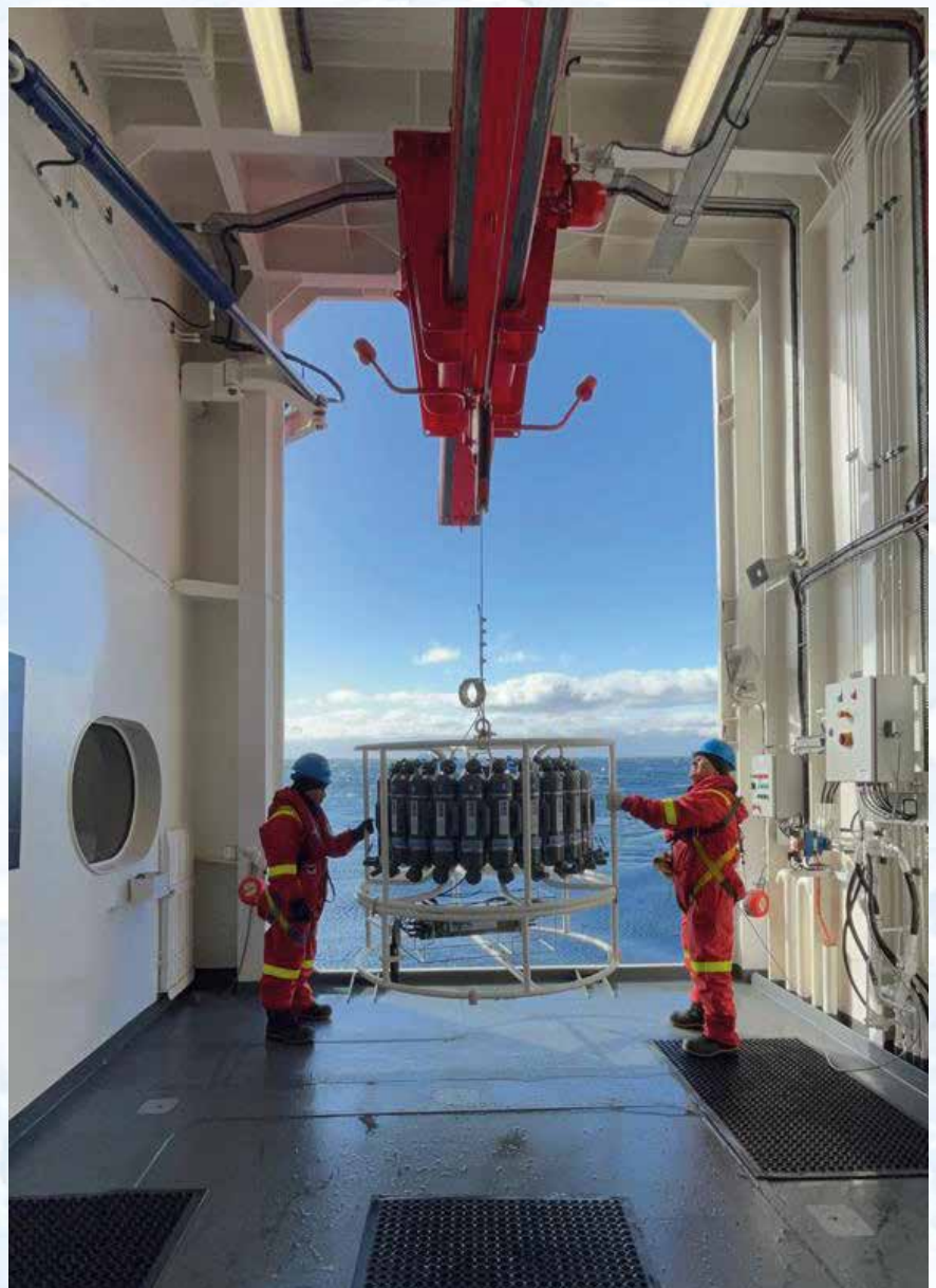
Figura 2. Despliegue de Roseta Oceanográfica, conteniendo 24 botellas Niskin y un CTD en la parte inferior, desde el hangar CTD del B.A.P "Carrasco".
