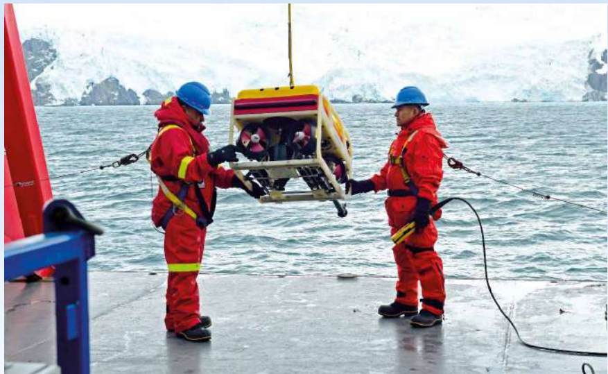
Figura 3. Despliegue del ROV por el personal encargado del monitoreo y exploración del fondo oceánico.
