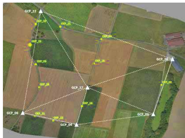
Vuelo en área de cultivo Precisión vertical del vuelo RTK: 2.7 cm, GCPs bien distribuidos: 6.6 cm. Puntos de control marcados en verde y el tamaño se refiere a los valores de error
