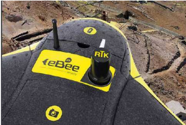
UAV RTK, Las posiciones de la cámara se calculan en tiempo real.
