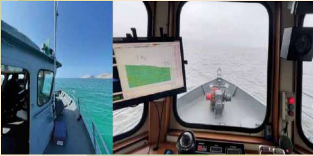
Figura 1: Levantamiento batimétrico multihaz a bordo de la Auxiliar Embarcación Hidrográfica A.E.H. 174 "Macha".
