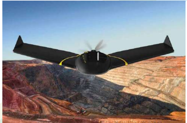
UAV no-RTK, con receptor GPS a bordo.
