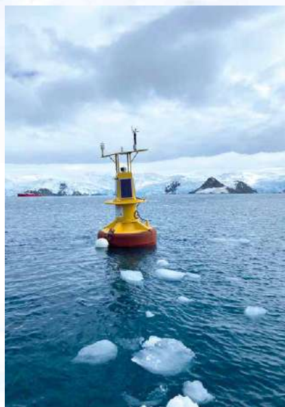
Figura 2. Boya de olas con paneles solares.
