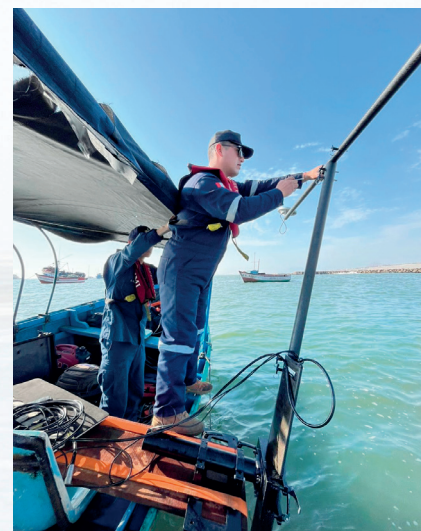
Figura 2. Levantamiento batimétrico multihaz.
