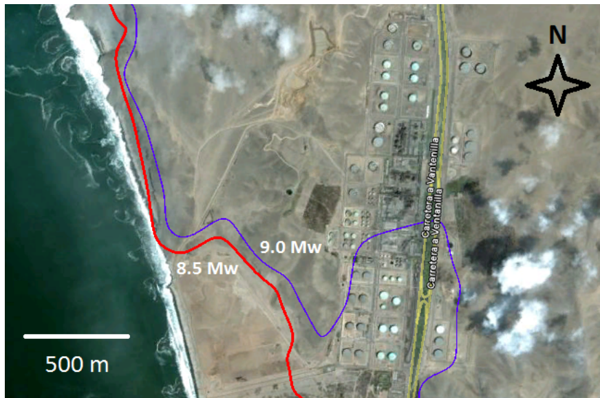
Fig. 6.9 Imagen satelital para la zona de la refinera La Pampilla, donde se observan los tanques de almacenamiento de combustible. La línea de inundación en color azul para el evento sísmico de 9.0 Mw. La parte sur de la refinera La Pampilla sería inundada. La parte norte de la refinera no sería afectada.
