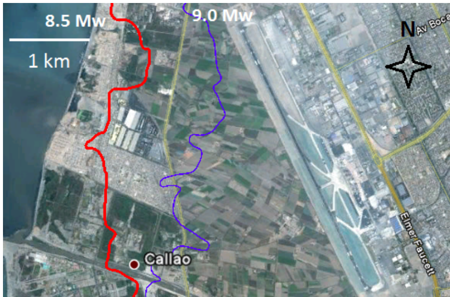
Fig. 6.11 Imagen satelital para la zona del aeropuerto Jorge Chávez. La inundación máxima está en color azul para el evento sísmico de 9.0 Mw. El aeropuerto internacional Jorge Chávez no sería afectado por la inundación del maremoto.
