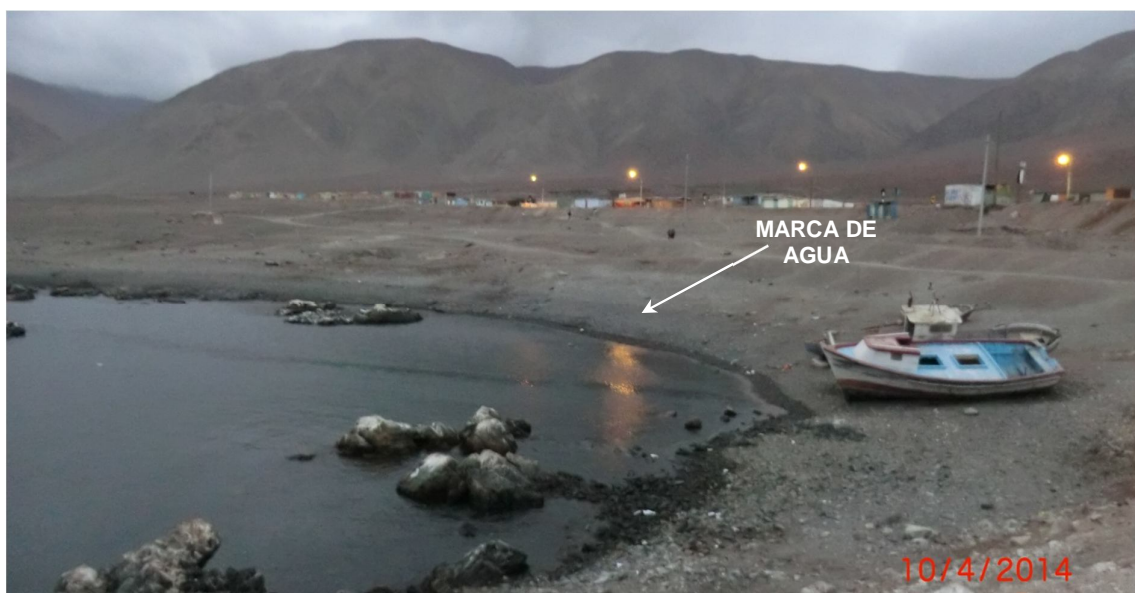
13. En este sector, la zona de inundación no hubo un retiro súbito pero si hubo una inundación de 7.36 m de inundación con un "runup" calculado de 2.35 m.
