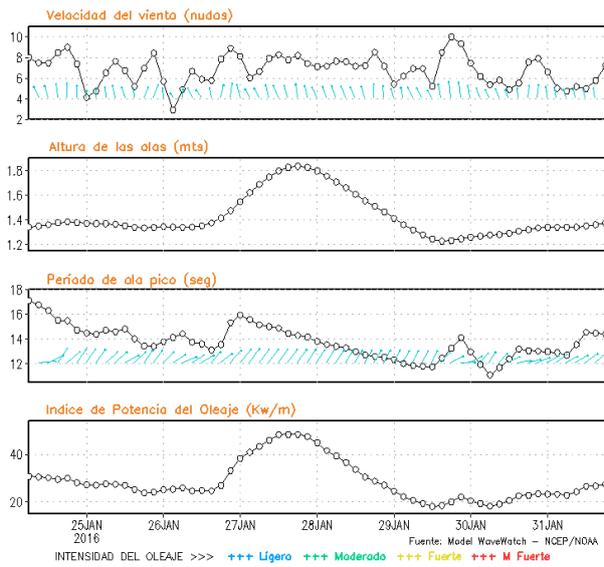
**Figura 8.** Series de tiempo de la velocidad del viento (nudos), altura de olas (m), periodo de la ola (s) e índice de la potencia del oleaje (Kw/m) frente a las costas de Talara, Callao e Ilo, del 24-01-2016 al 31-01-2016 Fuente: Datos: modelo WWATCH III; Grafico: DHN
