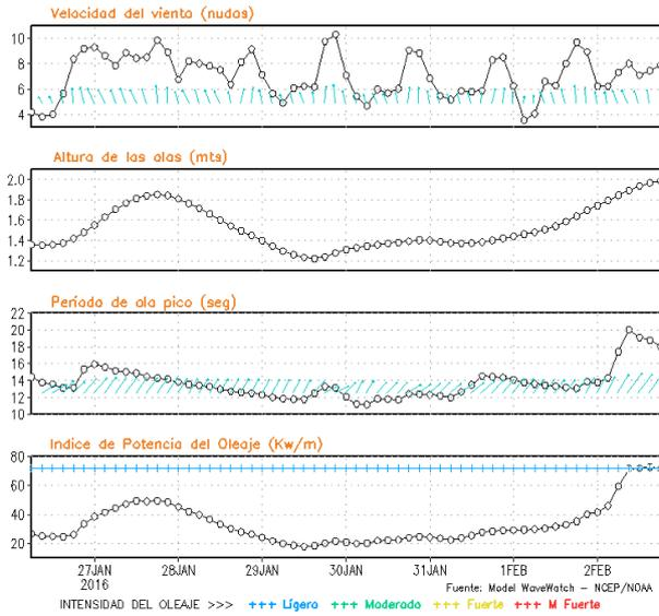
**Figura 8.** Series de tiempo de la velocidad del viento (nudos), altura de olas (m), periodo de la ola (s) e índice de la potencia del oleaje (Kw/m) frente a las costas de Talara, Callao e Ilo, del 26-01-2016 al 02-02-2016 Fuente: Datos: modelo WWATCH III; Grafico: DHN
