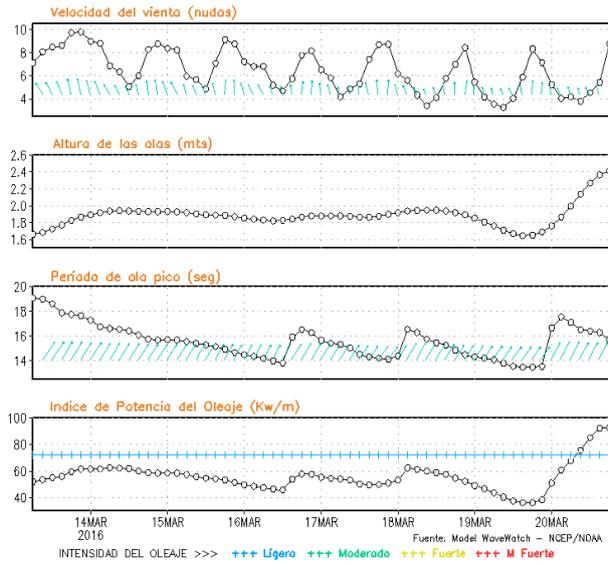
**Figura 8.** Series de tiempo de la velocidad del viento (nudos), altura de olas (m), periodo de la ola (s) e índice de la potencia del oleaje (Kw/m) frente a las costas de Talara, Callao e Ilo, del 13-03-2016 al 20-03-2016 Fuente: Datos: modelo WWATCH III; Grafico: DHN
