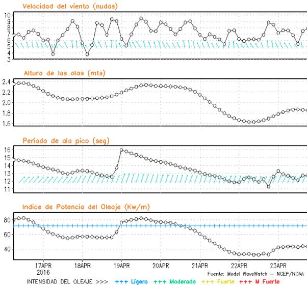
**Figura 8.** Series de tiempo de la velocidad del viento (nudos), altura de olas (m), periodo de la ola (s) e índice de la potencia del oleaje (Kw/m) frente a las costas de Talara, Callao e Ilo, del 16-04-2016 al 23-04-2016 Fuente: Datos: modelo WWATCH III; Grafico: DHN
