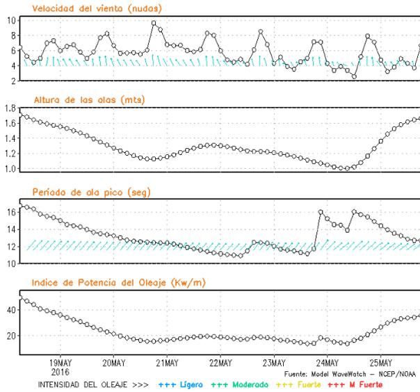
**Figura 8.** Series de tiempo de la velocidad del viento (nudos), altura de olas (m), periodo de la ola (s) e índice de la potencia del oleaje (Kw/m) frente a las costas de Talara, Callao e Ilo, del 18-05-2016 al 25-05-2016 Fuente: Datos: modelo WWATCH III; Grafico: DHN
