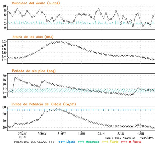
**Figura 8.** Series de tiempo de la velocidad del viento (nudos), altura de olas (m), periodo de la ola (s) e índice de la potencia del oleaje (Kw/m) frente a las costas de Talara, Callao e Ilo, del 28-05-2016 al 04-06-2016 Fuente: Datos: modelo WWATCH III; Grafico: DHN
