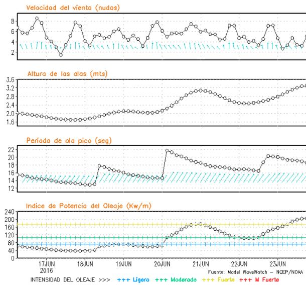
Figura 8. Series de tiempo de la velocidad del viento (nudos), altura de olas (m), periodo de la ola (s) e índice de la potencia del oleaje (Kw/m) frente a las costas de Talara, Callao e Ilo, del 16-06-2016 al 23-06-2016 Fuente: Datos: modelo WWATCH III; Grafico: DHN
