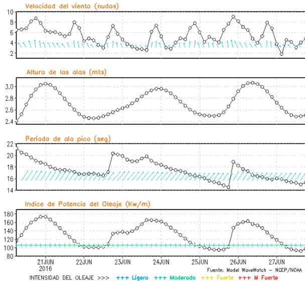
**Figura 8.** Series de tiempo de la velocidad del viento (nudos), altura de olas (m), periodo de la ola (s) e índice de la potencia del oleaje (Kw/m) frente a las costas de Talara, Callao e Ilo, del 20-06-2016 al 27-06-2016 Fuente: Datos: modelo WWATCH III; Grafico: DHN
