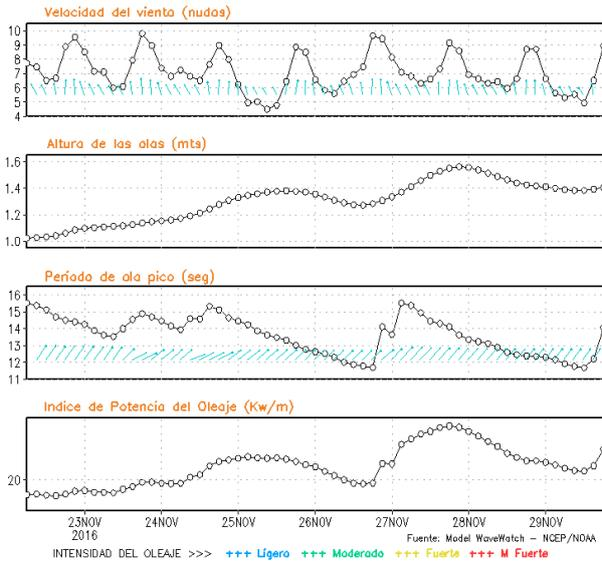
**Figura 8.** Series de tiempo de la velocidad del viento (nudos), altura de olas (m), periodo de la ola (s) e índice de la potencia del oleaje (Kw/m) frente a las costas de Talara, Callao e Ilo, del 22-11-2016 al 29-11-2016 Fuente: Datos: modelo WWATCH III; Grafico: DHN
