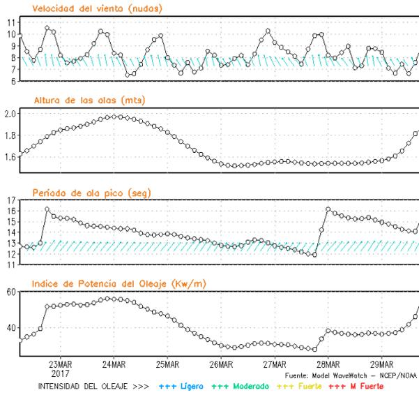
**Figura 8.** Series de tiempo de la velocidad del viento (nudos), altura de olas (m), periodo de la ola (s) e índice de la potencia del oleaje (Kw/m) frente a las costas de Talara, Callao e Ilo, del 22-03-2017 al 29-03-2017 Fuente: Datos: modelo WWATCH III; Grafico: DHN
