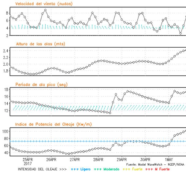
**Figura 8.** Series de tiempo de la velocidad del viento (nudos), altura de olas (m), periodo de la ola (s) e índice de la potencia del oleaje (Kw/m) frente a las costas de Talara, Callao e Ilo, del 24-04-2017 al 01-05-2017 Fuente: Datos: modelo WWATCH III; Grafico: DHN
