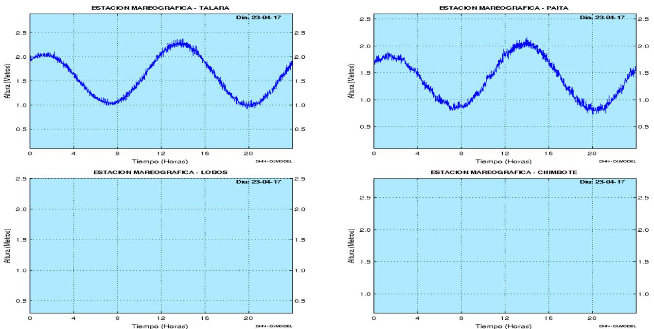
Figura 5. Mareogramas de las estaciones oceanográficas de Talara, Paita, Isla Lobos y Chimbote del día 23-04-2017 Fuente: División de Oceanografía DHN.
