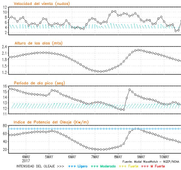
**Figura 8.** Series de tiempo de la velocidad del viento (nudos), altura de olas (m), periodo de la ola (s) e índice de la potencia del oleaje (Kw/m) frente a las costas de Talara, Callao e Ilo, del 03-05-2017 al 10-05-2017 Fuente: Datos: modelo WWATCH III; Grafico: DHN
