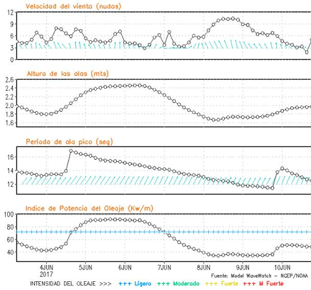
**Figura 8.** Series de tiempo de la velocidad del viento (nudos), altura de olas (m), periodo de la ola (s) e índice de la potencia del oleaje (Kw/m) frente a las costas de Talara, Callao e Ilo, del 03-06-2017 al 10-06-2017 Fuente: Datos: modelo WWATCH III; Grafico: DHN
