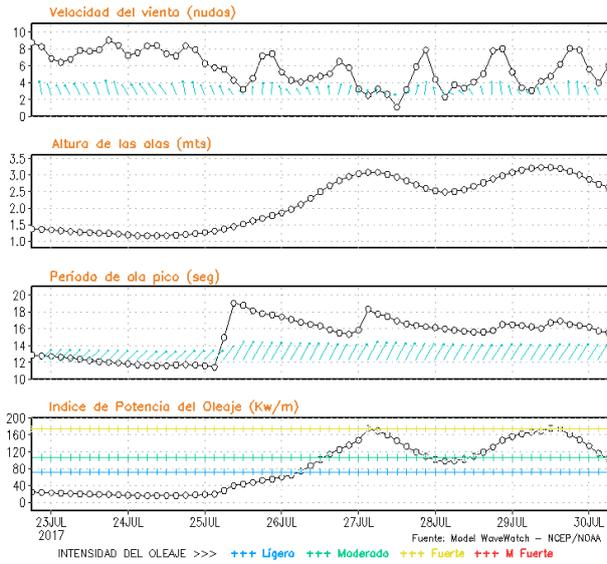
**Figura 8.** Series de tiempo de la velocidad del viento (nudos), altura de olas (m), periodo de la ola (s) e índice de la potencia del oleaje (Kw/m) frente a las costas de Talara, Callao e Ilo, del 22-07-2017 al 29-07-2017 Fuente: Datos: modelo WWATCH III; Grafico: DHN
