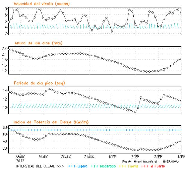
**Figura 8.** Series de tiempo de la velocidad del viento (nudos), altura de olas (m), periodo de la ola (s) e índice de la potencia del oleaje (Kw/m) frente a las costas de Talara, Callao e Ilo, del 27-08-2017 al 03-09-2017 Fuente: Datos: modelo WWATCH III; Grafico: DHN
