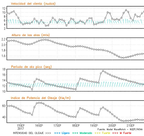
**Figura 8.** Series de tiempo de la velocidad del viento (nudos), altura de olas (m), periodo de la ola (s) e índice de la potencia del oleaje (Kw/m) frente a las costas de Talara, Callao e Ilo, del 14-09-2017 al 21-09-2017 Fuente: Datos: modelo WWATCH III; Grafico: DHN
