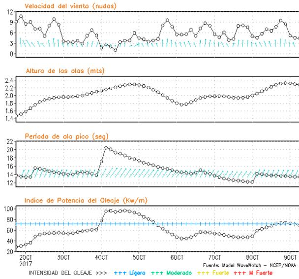
**Figura 8.** Series de tiempo de la velocidad del viento (nudos), altura de olas (m), periodo de la ola (s) e índice de la potencia del oleaje (Kw/m) frente a las costas de Talara, Callao e Ilo, del 01-10-2017 al 08-10-2017 Fuente: Datos: modelo WWATCH III; Grafico: DHN
