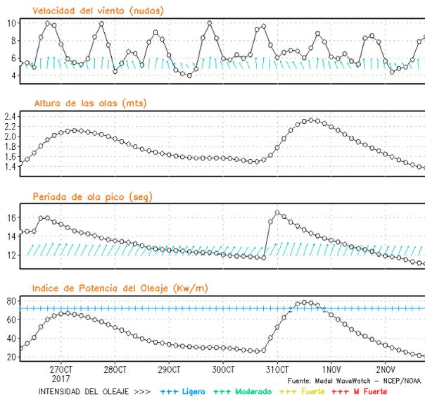
Figura 8. Series de tiempo de la velocidad del viento (nudos), altura de olas (m), periodo de la ola (s) e índice de la potencia del oleaje (Kw/m) frente a las costas de Talara, Callao e Ilo, del 26-10-2017 al 02-11-2017 Fuente: Datos: modelo WWATCH III; Grafico: DHN
