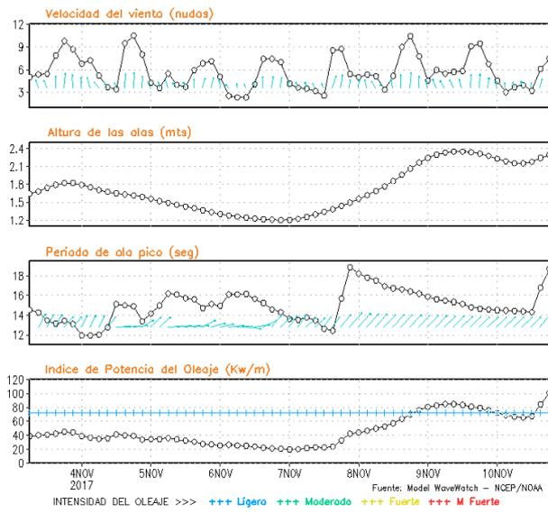
**Figura 8.** Series de tiempo de la velocidad del viento (nudos), altura de olas (m), periodo de la ola (s) e índice de la potencia del oleaje (Kw/m) frente a las costas de Talara, Callao e Ilo, del 03-11-2017 al 10-11-2017 Fuente: Datos: modelo WWATCH III; Grafico: DHN
