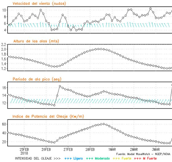
**Figura 8.** Series de tiempo de la velocidad del viento (nudos), altura de olas (m), periodo de la ola (s) e índice de la potencia del oleaje (Kw/m) frente a las costas de Talara, Callao e Ilo, del 24-02-2018 al 03-03-2018 Fuente: Datos: modelo WWATCH III; Grafico: DHN
