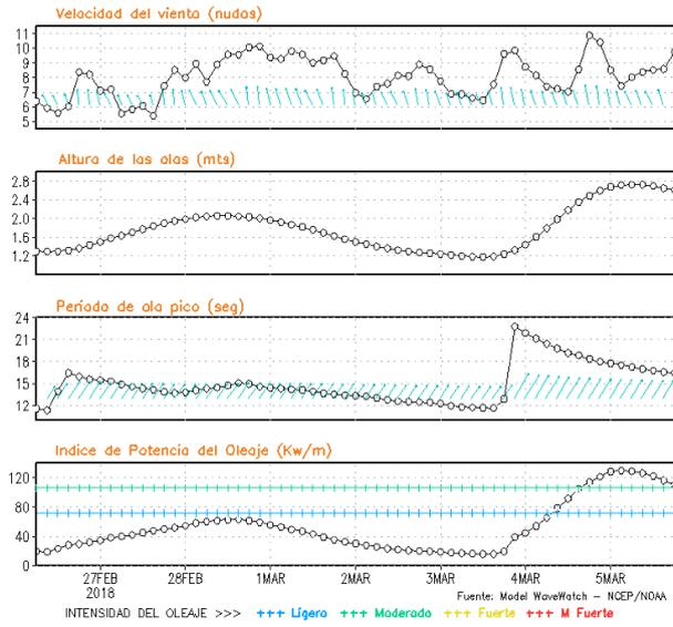
**Figura 8.** Series de tiempo de la velocidad del viento (nudos), altura de olas (m), periodo de la ola (s) e índice de la potencia del oleaje (Kw/m) frente a las costas de Talara, Callao e Ilo, del 26-02-2018 al 05-03-2018 Fuente: Datos: modelo WWATCH III; Grafico: DHN
