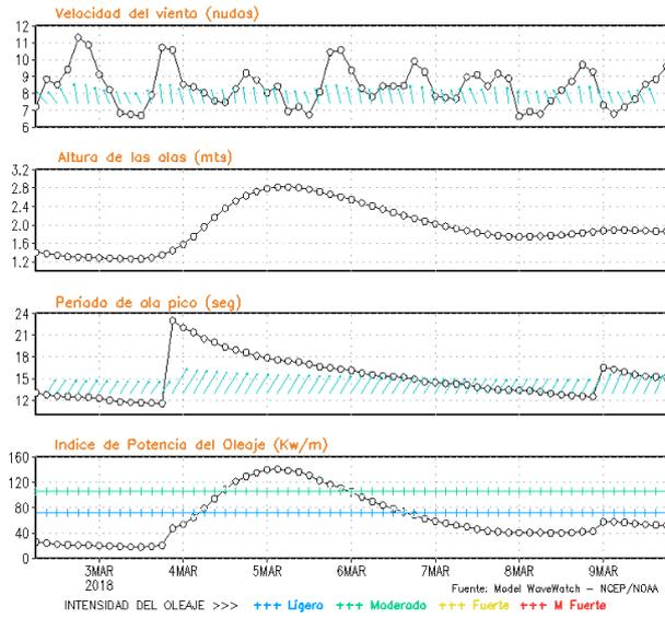
**Figura 8.** Series de tiempo de la velocidad del viento (nudos), altura de olas (m), periodo de la ola (s) e índice de la potencia del oleaje (Kw/m) frente a las costas de Talara, Callao e Ilo, del 02-03-2018 al 09-03-2018 Fuente: Datos: modelo WWATCH III; Grafico: DHN
