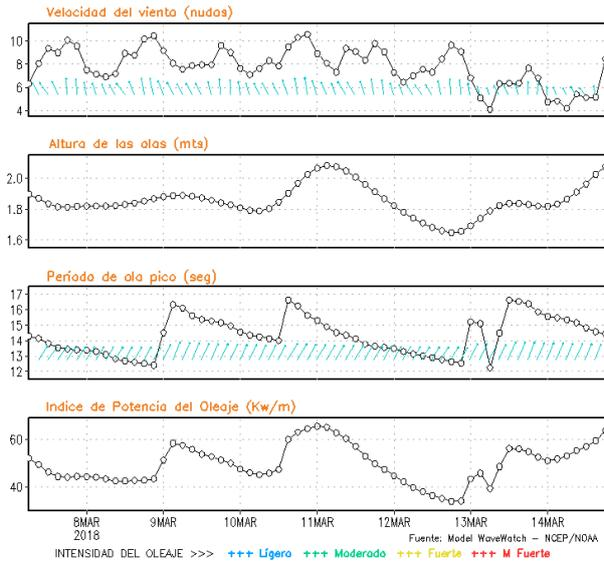
**Figura 8.** Series de tiempo de la velocidad del viento (nudos), altura de olas (m), periodo de la ola (s) e índice de la potencia del oleaje (Kw/m) frente a las costas de Talara, Callao e Ilo, del 07-03-2018 al 14-03-2018 Fuente: Datos: modelo WWATCH III; Grafico: DHN
