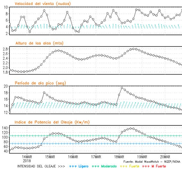
**Figura 8.** Series de tiempo de la velocidad del viento (nudos), altura de olas (m), periodo de la ola (s) e índice de la potencia del oleaje (Kw/m) frente a las costas de Talara, Callao e Ilo, del 13-03-2018 al 20-03-2018 Fuente: Datos: modelo WWATCH III; Grafico: DHN
