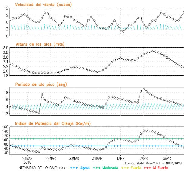
**Figura 8.** Series de tiempo de la velocidad del viento (nudos), altura de olas (m), periodo de la ola (s) e índice de la potencia del oleaje (Kw/m) frente a las costas de Talara, Callao e Ilo, del 27-03-2018 al 03-04-2018 Fuente: Datos: modelo WWATCH III; Grafico: DHN
