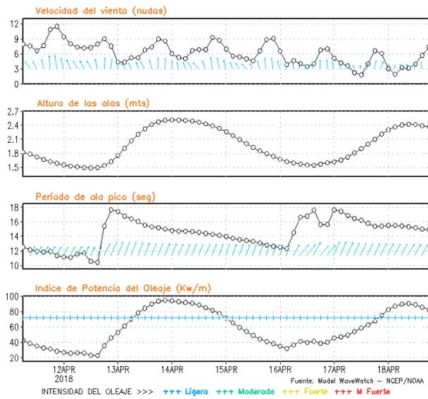
**Figura 8.** Series de tiempo de la velocidad del viento (nudos), altura de olas (m), periodo de la ola (s) e índice de la potencia del oleaje (Kw/m) frente a las costas de Talara, Callao e Ilo, del 11-04-2018 al 18-04-2018 Fuente: Datos: modelo WWATCH III; Grafico: DHN
