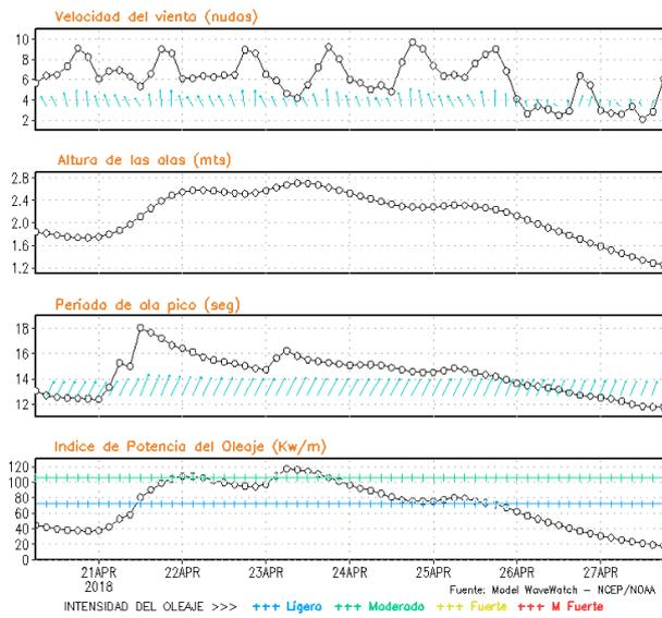
**Figura 8.** Series de tiempo de la velocidad del viento (nudos), altura de olas (m), periodo de la ola (s) e índice de la potencia del oleaje (Kw/m) frente a las costas de Talara, Callao e Ilo, del 20-04-2018 al 27-04-2018 Fuente: Datos: modelo WWATCH III; Grafico: DHN
