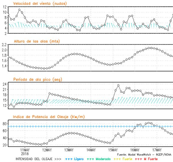
**Figura 8.** Series de tiempo de la velocidad del viento (nudos), altura de olas (m), periodo de la ola (s) e índice de la potencia del oleaje (Kw/m) frente a las costas de Talara, Callao e Ilo, del 10-05-2018 al 17-05-2018 Fuente: Datos: modelo WWATCH III; Grafico: DHN
