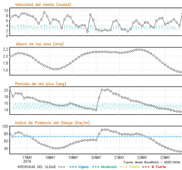
Figura 8. Series de tiempo de la velocidad del viento (nudos), altura de olas (m), periodo de la ola (s) e índice de la potencia del oleaje (Kw/m) frente a las costas de Talara, Callao e Ilo, del 16-05-2018 al 23-05-2018 Fuente: Datos: modelo WWATCH III; Grafico: DHN
