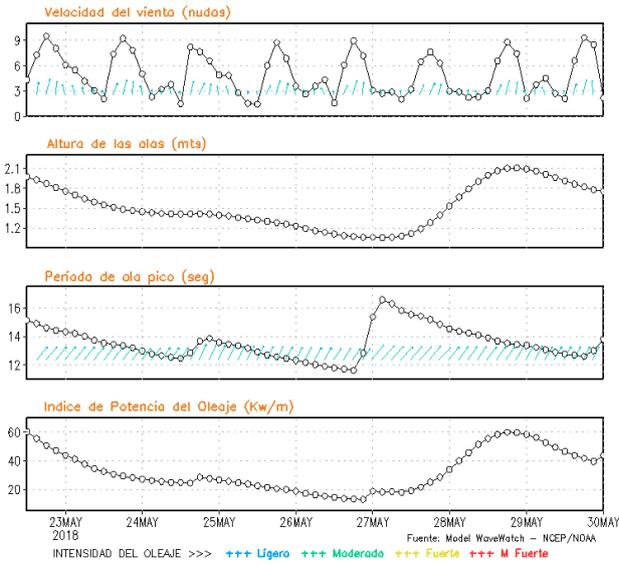
**Figura 8.** Series de tiempo de la velocidad del viento (nudos), altura de olas (m), periodo de la ola (s) e índice de la potencia del oleaje (Kw/m) frente a las costas de Talara, Callao e Ilo, del 22-05-2018 al 29-05-2018 Fuente: Datos: modelo WWATCH III; Grafico: DHN
