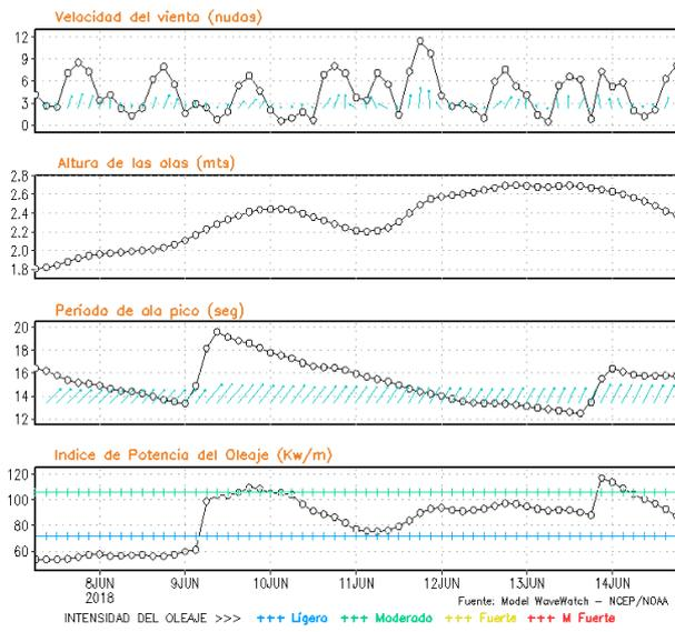
**Figura 8.** Series de tiempo de la velocidad del viento (nudos), altura de olas (m), periodo de la ola (s) e índice de la potencia del oleaje (Kw/m) frente a las costas de Talara, Callao e Ilo, del 07-06-2018 al 14-06-2018 Fuente: Datos: modelo WWATCH III; Grafico: DHN
