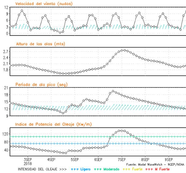
**Figura 8.** Series de tiempo de la velocidad del viento (nudos), altura de olas (m), periodo de la ola (s) e índice de la potencia del oleaje (Kw/m) frente a las costas de Talara, Callao e Ilo, del 02-09-2018 al 09-09-2018 Fuente: Datos: modelo WWATCH III; Grafico: DHN
