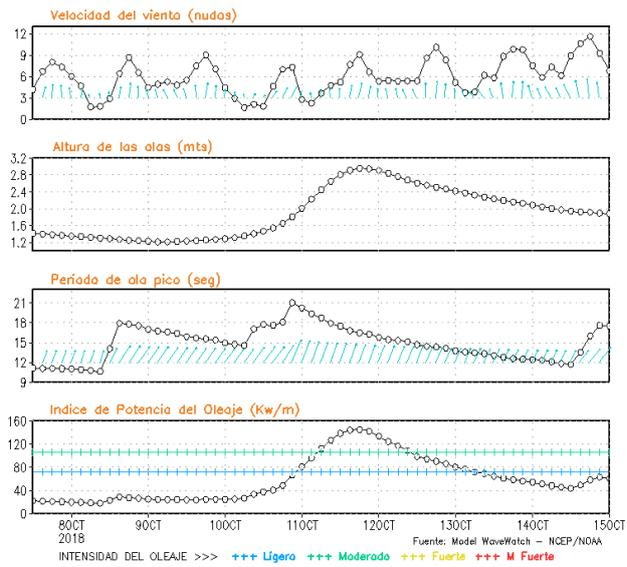
**Figura 8.** Series de tiempo de la velocidad del viento (nudos), altura de olas (m), periodo de la ola (s) e índice de la potencia del oleaje (Kw/m) frente a las costas de Talara, Callao e Ilo, del 07-10-2018 al 14-10-2018 Fuente: Datos: modelo WWATCH III; Grafico: DHN
