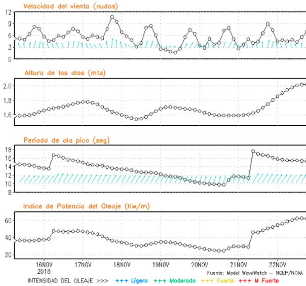
**Figura 8.** Series de tiempo de la velocidad del viento (nudos), altura de olas (m), periodo de la ola (s) e índice de la potencia del oleaje (Kw/m) frente a las costas de Talara, Callao e Ilo, del 15-11-2018 al 22-11-2018 Fuente: Datos: modelo WWATCH III; Grafico: DHN
