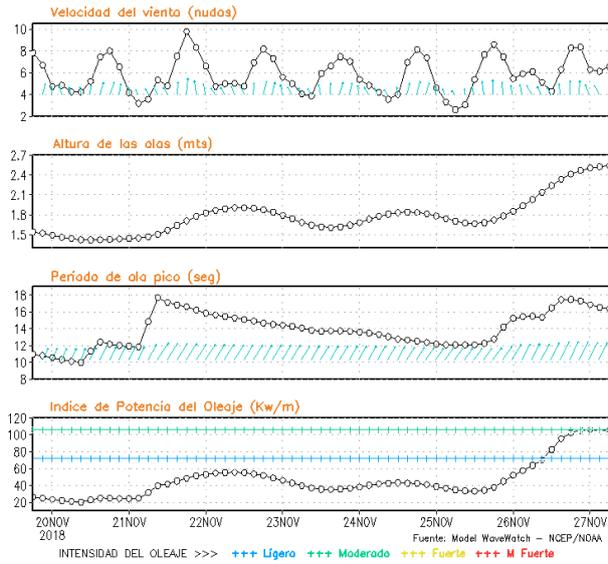
**Figura 8.** Series de tiempo de la velocidad del viento (nudos), altura de olas (m), periodo de la ola (s) e índice de la potencia del oleaje (Kw/m) frente a las costas de Talara, Callao e Ilo, del 19-11-2018 al 26-11-2018 Fuente: Datos: modelo WWATCH III; Grafico: DHN
