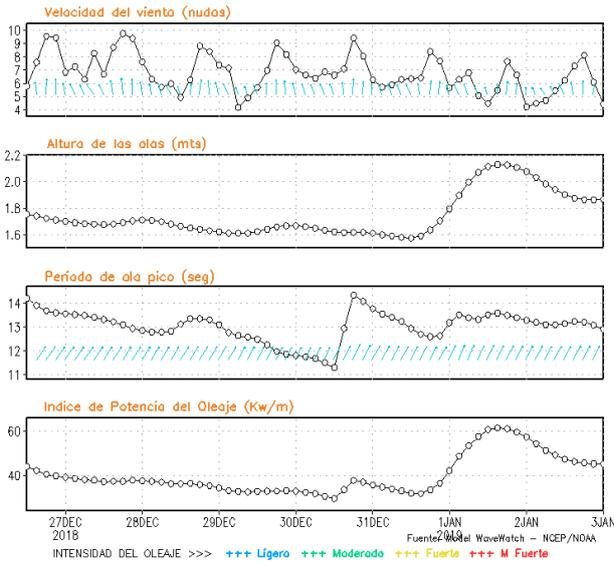
**Figura 8.** Series de tiempo de la velocidad del viento (nudos), altura de olas (m), periodo de la ola (s) e índice de la potencia del oleaje (Kw/m) frente a las costas de Talara, Callao e Ilo, del 27-12-2018 al 03-01-2019 Fuente: Datos: modelo WWATCH III; Grafico: DHN
