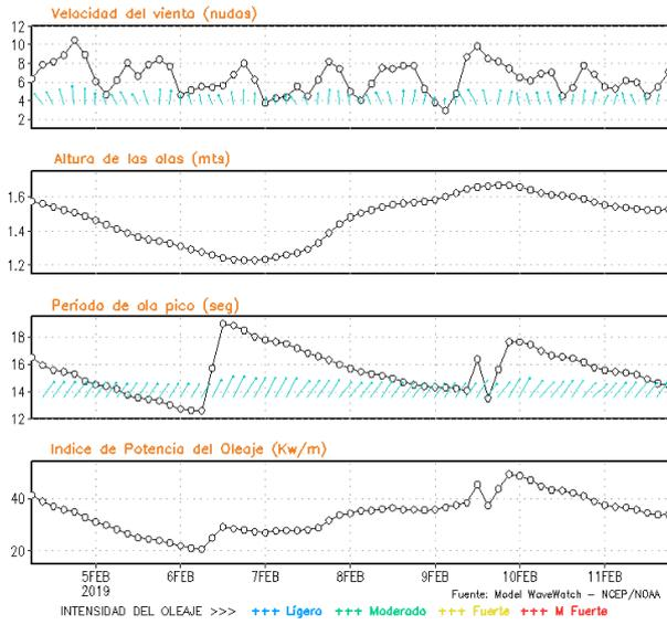
**Figura 8.** Series de tiempo de la velocidad del viento (nudos), altura de olas (m), periodo de la ola (s) e índice de la potencia del oleaje (Kw/m) frente a las costas de Talara, Callao e Ilo, del 04-02-2019 al 11-02-2019 Fuente: Datos: modelo WWATCH III; Grafico: DHN
