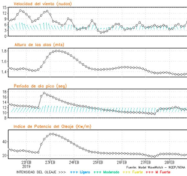
**Figura 8.** Series de tiempo de la velocidad del viento (nudos), altura de olas (m), periodo de la ola (s) e índice de la potencia del oleaje (Kw/m) frente a las costas de Talara, Callao e Ilo, del 21-02-2019 al 28-02-2019 Fuente: Datos: modelo WWATCH III; Grafico: DHN
