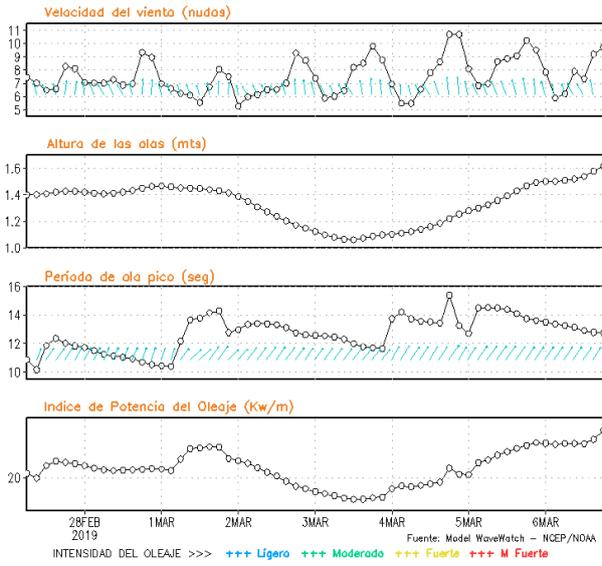
**Figura 8.** Series de tiempo de la velocidad del viento (nudos), altura de olas (m), periodo de la ola (s) e índice de la potencia del oleaje (Kw/m) frente a las costas de Talara, Callao e Ilo, del 27-02-2019 al 06-03-2019 Fuente: Datos: modelo WWATCH III; Grafico: DHN
