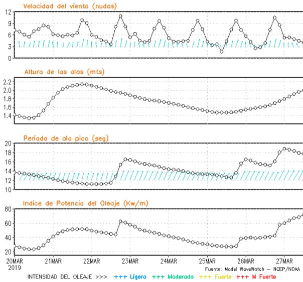
**Figura 8.** Series de tiempo de la velocidad del viento (nudos), altura de olas (m), periodo de la ola (s) e índice de la potencia del oleaje (Kw/m) frente a las costas de Talara, Callao e Ilo, del 20-03-2019 al 27-03-2019 Fuente: Datos: modelo WWATCH III; Grafico: DHN
