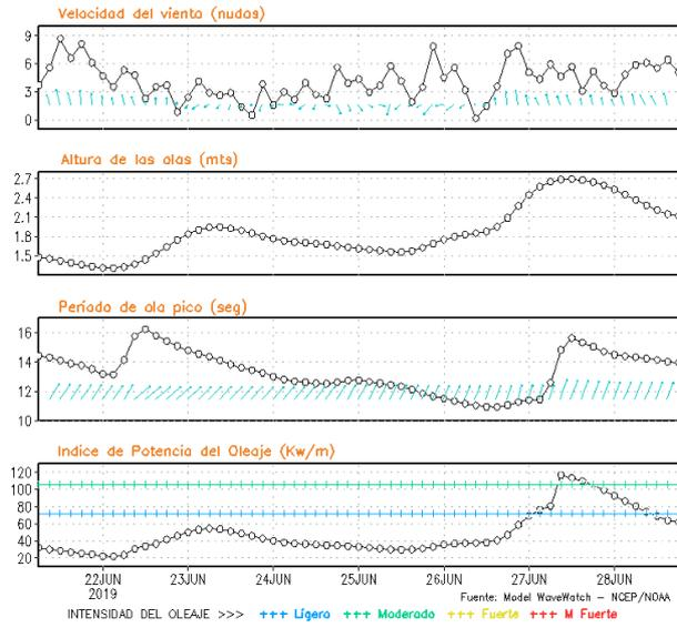
**Figura 8.** Series de tiempo de la velocidad del viento (nudos), altura de olas (m), periodo de la ola (s) e índice de la potencia del oleaje (Kw/m) frente a las costas de Talara, Callao e Ilo, del 21-06-2019 al 28-06-2019 Fuente: Datos: modelo WWATCH III; Grafico: DHN
