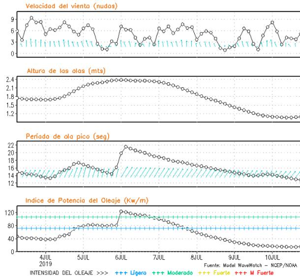
**Figura 8.** Series de tiempo de la velocidad del viento (nudos), altura de olas (m), periodo de la ola (s) e índice de la potencia del oleaje (Kw/m) frente a las costas de Talara, Callao e Ilo, del 03-07-2019 al 10-07-2019 Fuente: Datos: modelo WWATCH III; Grafico: DHN
