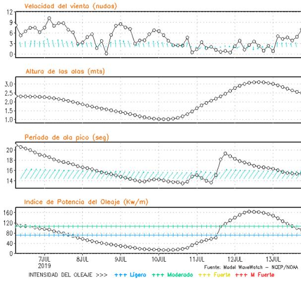
**Figura 8.** Series de tiempo de la velocidad del viento (nudos), altura de olas (m), periodo de la ola (s) e índice de la potencia del oleaje (Kw/m) frente a las costas de Talara, Callao e Ilo, del 06-07-2019 al 13-07-2019 Fuente: Datos: modelo WWATCH III; Grafico: DHN
