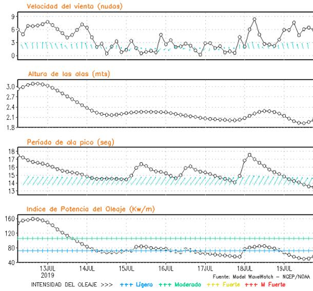
**Figura 8.** Series de tiempo de la velocidad del viento (nudos), altura de olas (m), periodo de la ola (s) e índice de la potencia del oleaje (Kw/m) frente a las costas de Talara, Callao e Ilo, del 12-07-2019 al 19-07-2019 Fuente: Datos: modelo WWATCH III; Grafico: DHN
