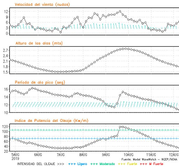
**Figura 8.** Series de tiempo de la velocidad del viento (nudos), altura de olas (m), periodo de la ola (s) e índice de la potencia del oleaje (Kw/m) frente a las costas de Talara, Callao e Ilo, del 04-08-2019 al 11-08-2019 Fuente: Datos: modelo WWATCH III; Grafico: DHN
