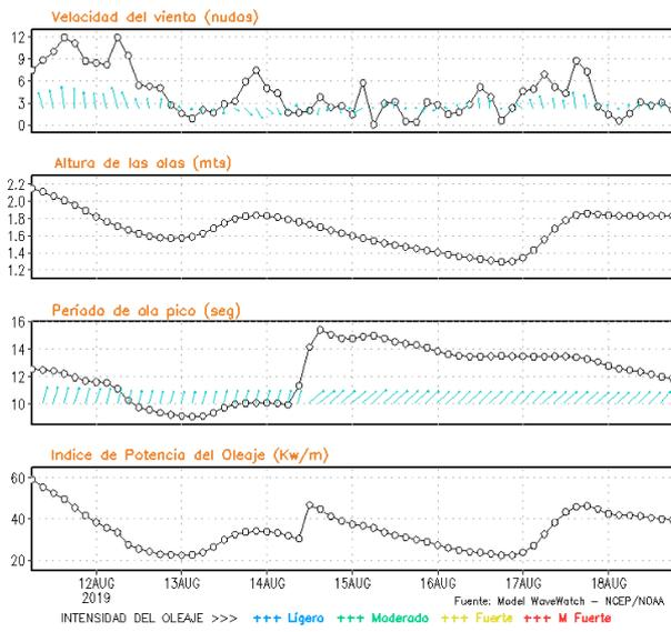
**Figura 8.** Series de tiempo de la velocidad del viento (nudos), altura de olas (m), periodo de la ola (s) e índice de la potencia del oleaje (Kw/m) frente a las costas de Talara, Callao e Ilo, del 11-08-2019 al 18-08-2019 Fuente: Datos: modelo WWATCH III; Grafico: DHN
